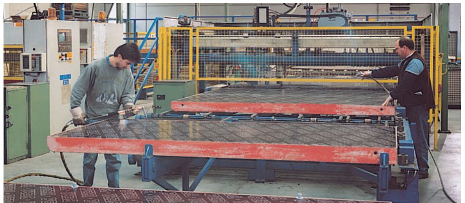
Nova šper ploča se za očišćeni ram precizno vezuje nitnama, a ivice spojeva se ispunjavaju silikonom
