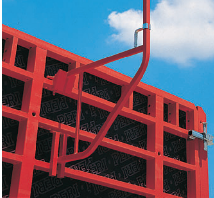
Kaćenje na horizontalno rebro
