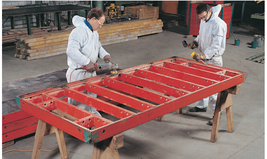
Uklanjanje nitni i čišćenje rama.
