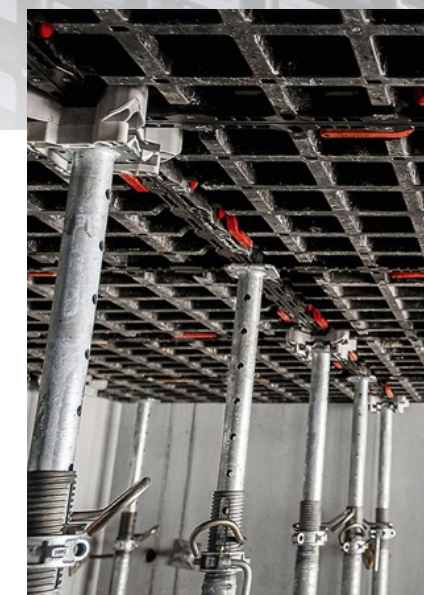
System umożliwia bezpieczne deskowania stropów o grubości do 30 cm z poziomu podłoża.
