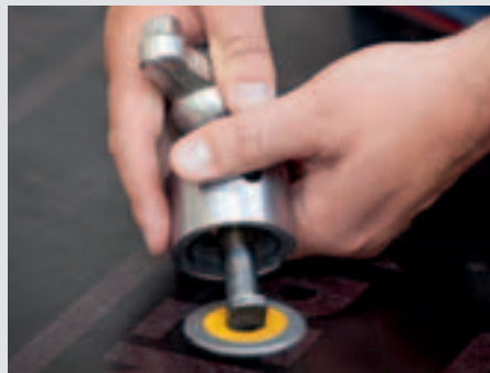
Zmiana uszczelki wymiennej z MX 15 ...
