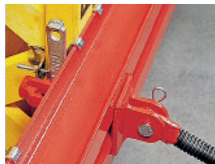
商品番号 028060 スチールウェール用 プロップ材接続金具と商品番号 024250 ウェッジK を使用してスチールウェール SRZに接続します
